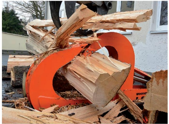
Die mobile Zange wird von der Traktorhydraulik angetrieben und läßt sich ortsunabhängig fast überall einsetzen.
