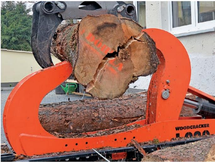
Mit bis zu 22 Tonnen Druckkraft spaltet der Woodcracker L 920 auch stärkstes Holz mühelos. Beim Aufbrechen der frischen Stämme tropft das Wasser wie aus einem Schwamm heraus. Fotos: Riemann
