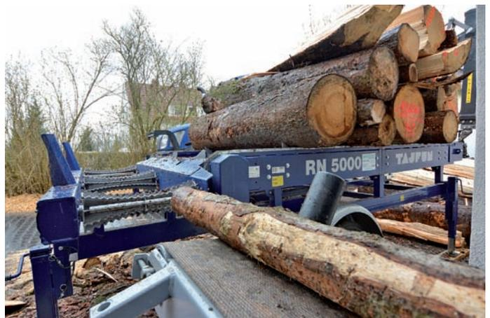
... der die Zwei-Meter-Stämme hydraulisch zum Tajfun-Sägespalter befördert.
