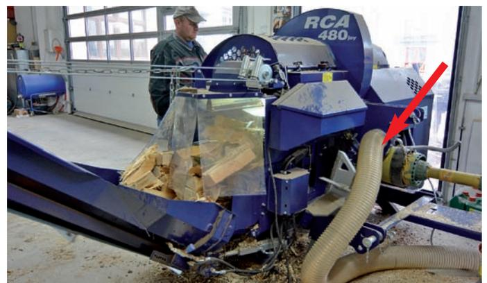
Als Wind- und Wärmeschutz zwischen Sägespalter und Zuführtisch dient ein Streifenvorhang. Die Sägespäne werden durch eine Absauganlage (Pfeil) über eine Strecke von etwa 25 Metern in einen Spänebunker neben dem Heizkessel geblasen. Der Antrieb per Zapfwelle erfolgt mit einem Elektro-Aggregat.
