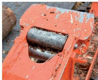
Reibrollen an der Druckseite des Zangenspalters verringern den Kraftaufwand beim Spalten.
