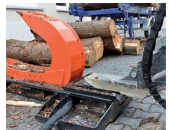
Durch einen hydraulischen Stützfuß des Rückewagens erhält der L 920 hundertprozentige Standsicherheit.
